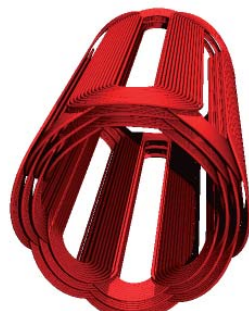
Illustration af et oktopolmagnetfelt dannet med små stangmagneter.
